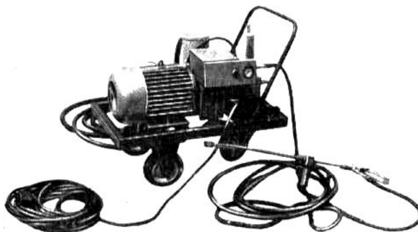
Рисунок 3 - Струйная мобильная моечная машина ОМ-5361-ГОСНИТИ
